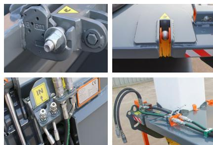
Замена комплекта осуществляется с помощью быстроразъемных муфт как в механической, так и в гидравлической части.
